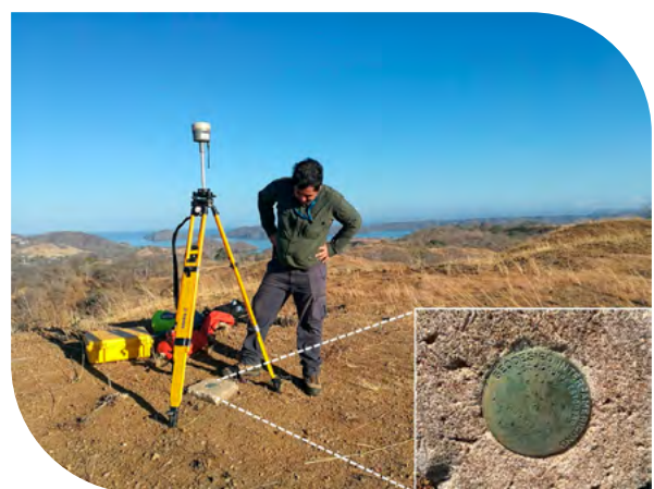
Fig. 5. Monumentación pasiva de la Red Geodésica Nacional (RGN) en el Hito Grande, Guanacaste, Costa Rica con detalle de la placa (elaboración propia)
