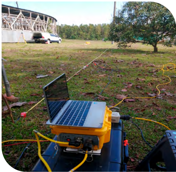
Figura 10. Perfil de prospección de refracción sísmica para futura monumentación GNSS (estación PJMZ), Puerto Jimenez, Costa Rica (elaboración propia)
