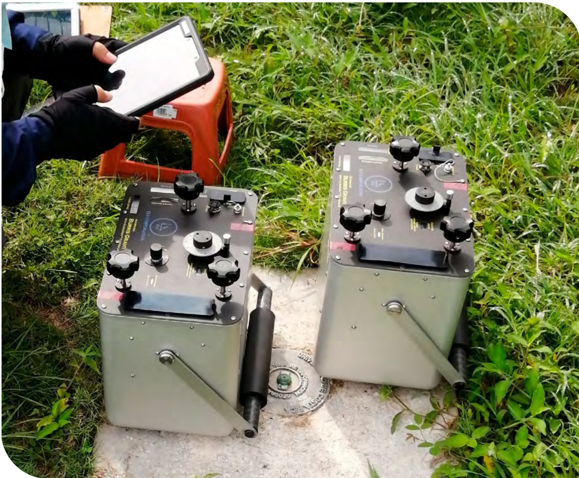
Fig. 6. Monumentación pasiva de la red gravimétrica absoluta (estación QUEP), Quepos, Costa Rica (elaboración propia)
