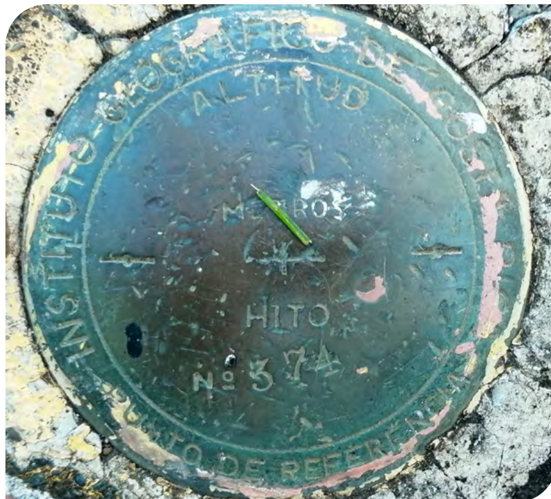
Fig. 2. Detalle de placa monumentación de la red geodésica vertical del Banco de Nivel #374 en Iglesia de Barva, Heredia Costa Rica (elaboración propia)
