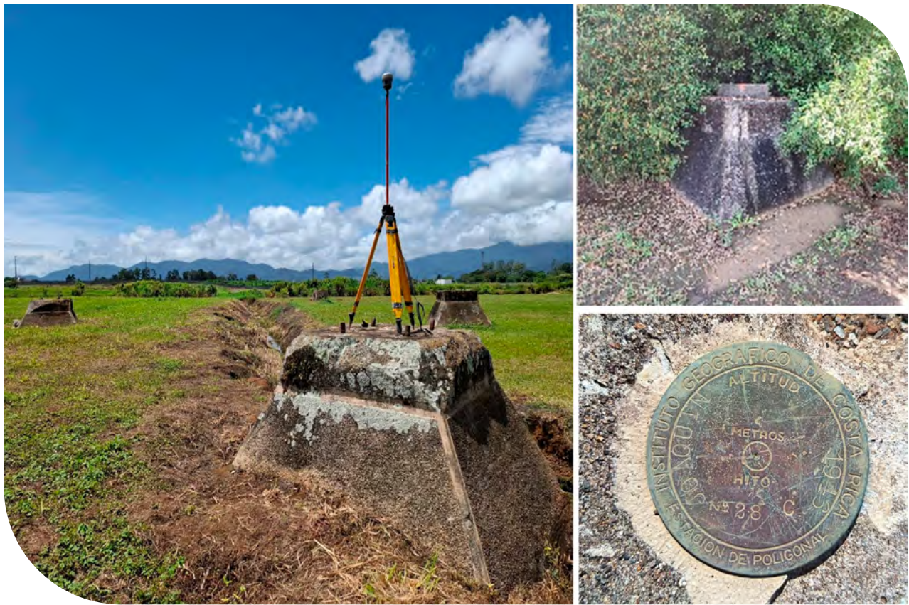
Fig. 7. Hito geodésico en detalle del año 1946, en cimientos de antigua estación telegráfica de RACSA en Paraíso de Cartago, en detalle hito N° 28 o “Joaquín” (ver placa), (elaboración propia)
