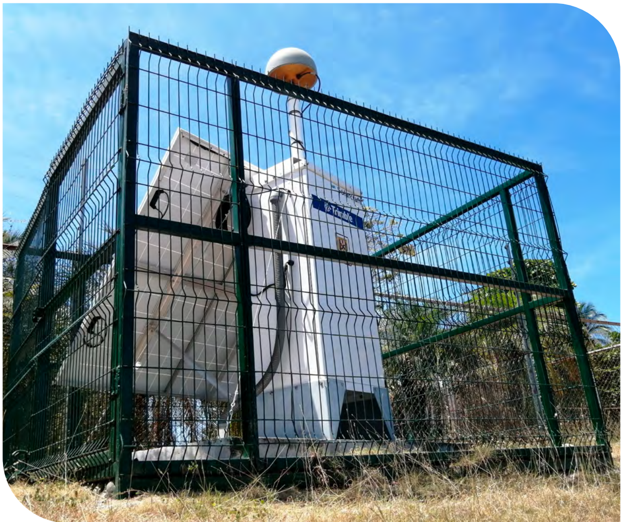
Fig. 4. Monumentación activa autónoma (GNSS) del sistema geodésico horizontal de Costa Rica SIRGAS-CON (estación QUEP), Quepos, Costa Rica (elaboración propia)
