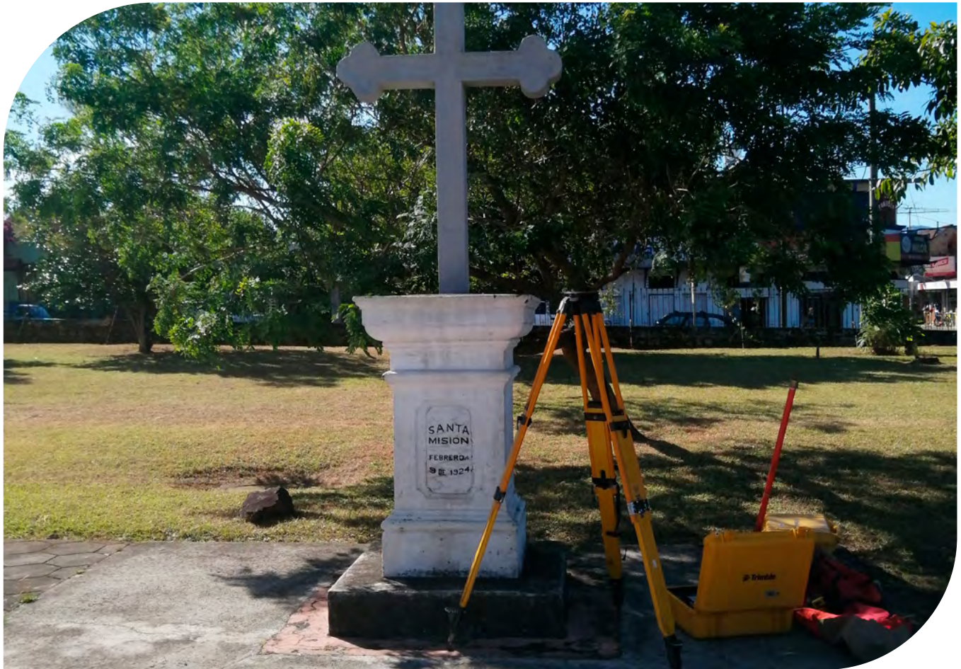
Fig. 3. Monumentación pasiva de la red geodésica vertical del Banco de Nivel #374 (bajo el trípede) en Iglesia de Barva, Heredia Costa Rica (elaboración propia)
