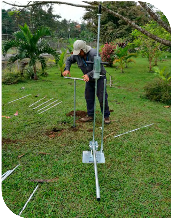
Figura 11. Uso (al fondo) de Auger y presencia de DPL (al frente) en sitio propuesto para estación GNSS en Bribri, Limón, Costa Rica (elaboración propia)
