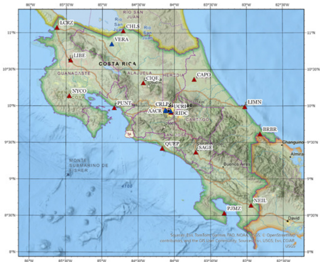
Figura 6. Red de estaciones de medición continua que forman la red activa de Costa Rica. Elaboración propia
