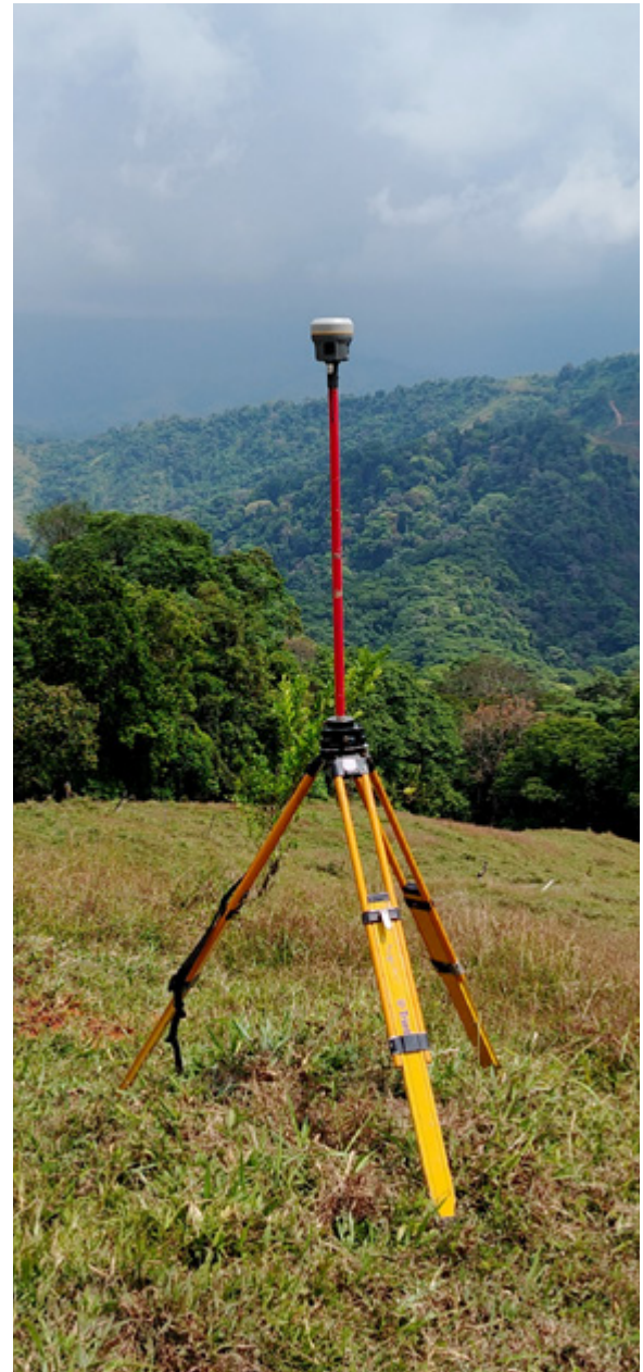
Figura 4. Antena modelo TRMR10 sin domo Fuente: Subproceso Geodinámica IGN
